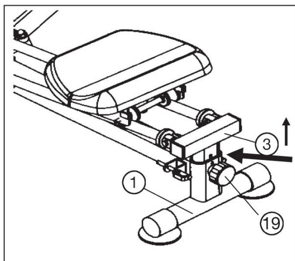
**Примечание. Не вытягивайте задний регулятор наклона (3) дальше маркированной макс. линии.**
