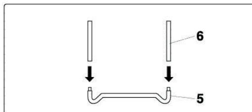
Вставьте вертикальный удлинитель (5) в нижнюю часть ножки согласно рисунку.
