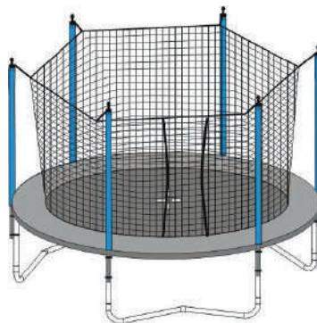
Закрепите верхнюю часть защитной сетки на опорах с помощью специальных ремней (входят в комплект батута), которые, после затягивания на опоре защитной сетки, необходимо продеть в металлические проушины расположенные на верхней части защитной сетки и затянуть их, как показано на рисунках ниже.
