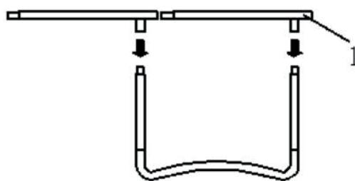
Для данного процесса нужно два человека. Один человек поднимает собранные нижние ножки, шаг 1, вертикально и вставляет один из наконечников стойки для защитной сетки (3) в вертикальный удлинитель ножек. Другой человек держит другой конец и вставляет эту часть в другие нижние ножки как на рисунки. Теперь Вы собрали две нижние ножки, которые крепятся к 2-м стойкам для защитной сетки.
