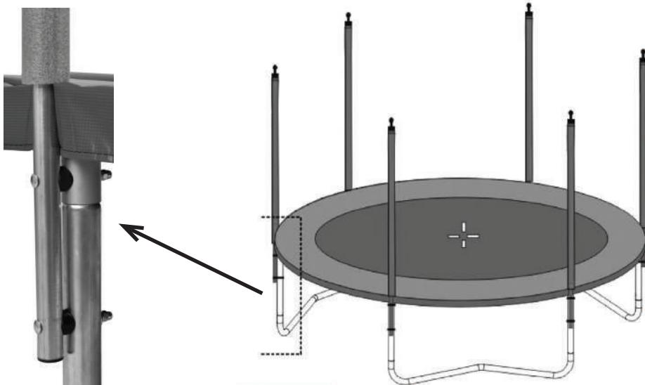
Для установки стоек защитной сети батута используются специальные крепления (2 крепления на каждую стойку). Сначала наденьте крепления на нижнюю часть стойки защитной сети (крепления имеют металлические дуги, в которые необходимо продеть стойку), затем проденьте болты креплений в отверстия, расположенные на опорах рамы батута и закрепите их гайками.
